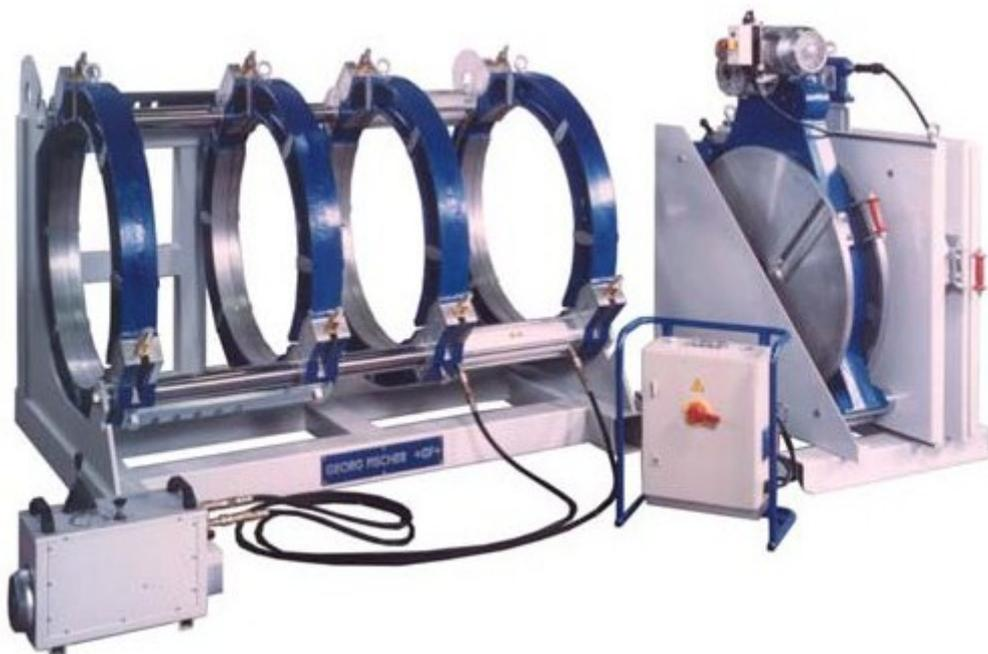
MACHINE à POLYFUSER BOUT à BOUT MANUELLE P 110 Ø25 à 110 PN 16
