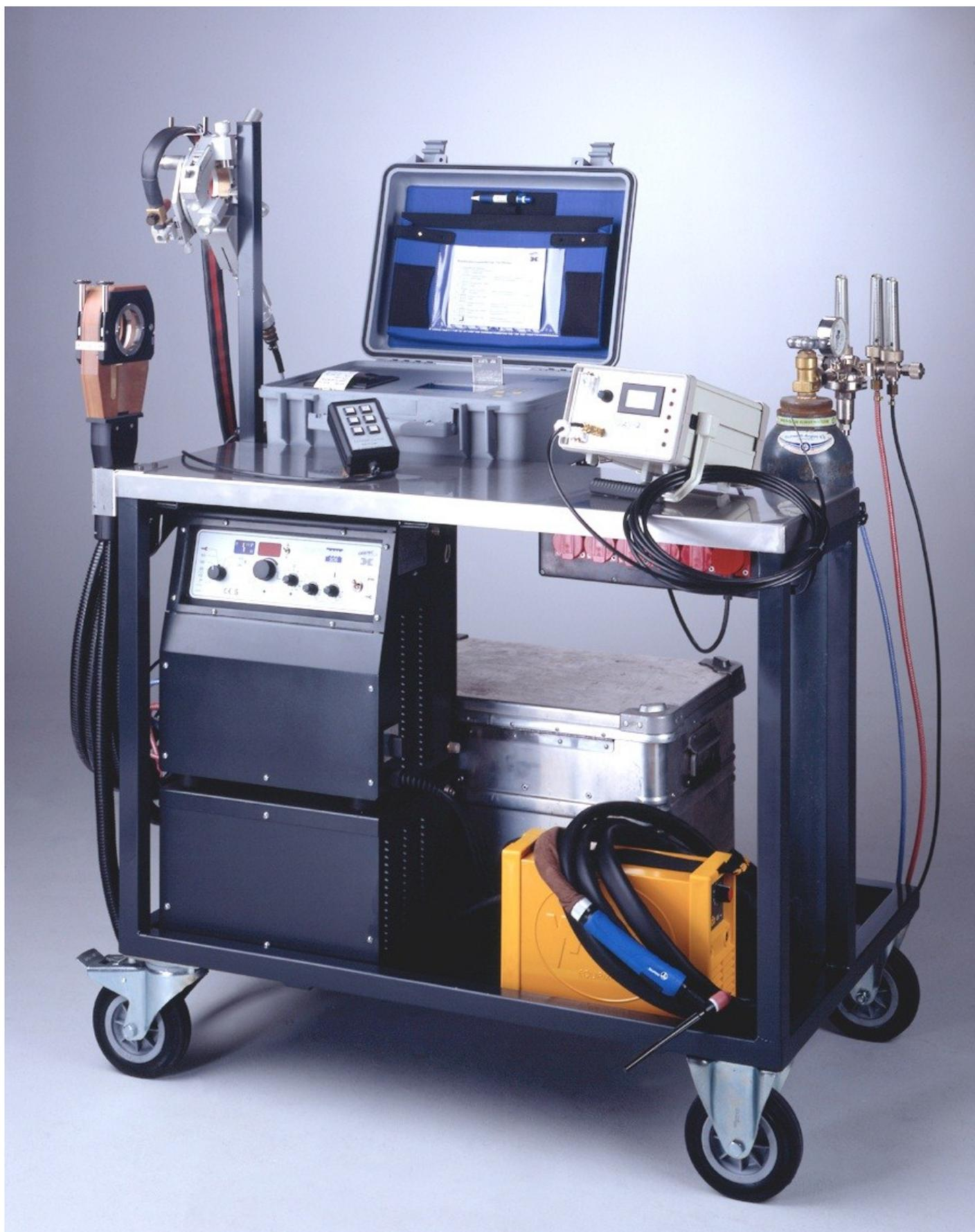
GENERATEUR ORBITALE ORBITEC complet sur chariot et imprimante
