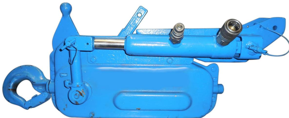
Le treuil hydraulique Tirfor est un treuil motorisé mobile à câble passant. Il peut lever, tirer et positionner des charges sur une grande longueur tout en gardant leur capacité de traction. Il peut être utilisé dans de multiples configurations.
