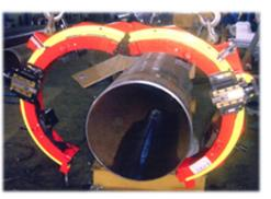
La conception de cette machine permet des usinages dans de très grands diamètres à forte épaisseur. La conception de cette machine permet des usinages dans de très grands diamètres à forte épaisseur. La conception de cette machine permet des usinages dans de très grands diamètres à forte épaisseur.
