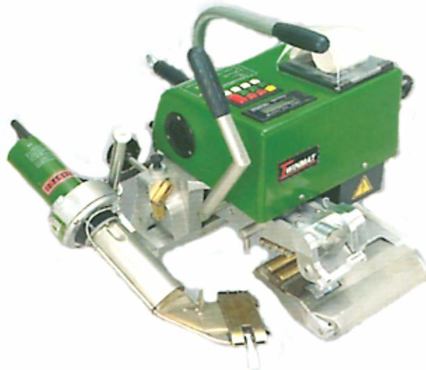
Le **TWINMAT** est une soudeuse automatique à air chaud pour soudage par recouvrement de feuilles d'étanchéité dans les chantiers enterrés ou hydrauliques.
