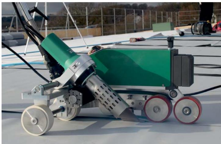
Notre version classique d'automate de soudage dans sa forme éprouvée
