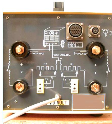
Appareil électronique de régulation et de contrôle pour le traitement thermique de préchauffage et postchauffage, avec utilisation d'une soudeuse électrique comme générateur de puissance.
