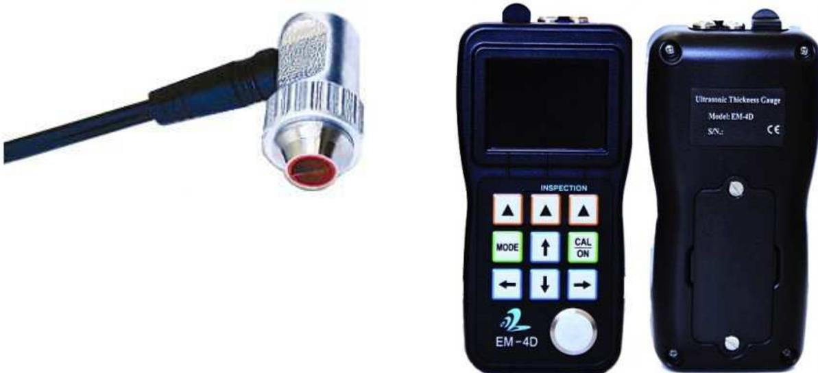
Appareil à ultra-son pour mesure d'épaisseur d'une large variété de matériaux tels que acier, plastique, verre, céramique et autres matériaux homogènes.
