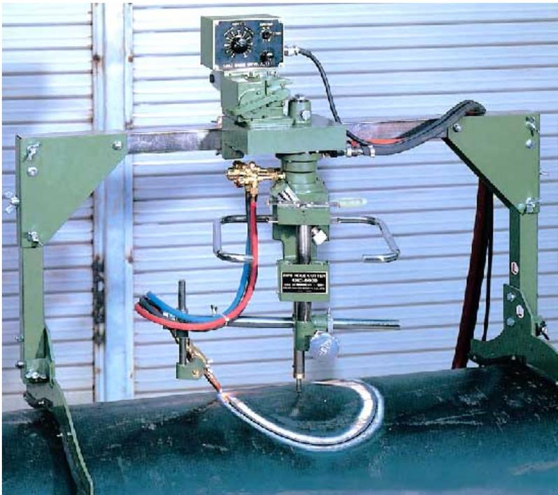
Machine conçue pour le découpage de haute précision d'ouvertures dans les viroles, citernes, échangeurs thermiques pour la pose de brides et piquages à angle droit.
