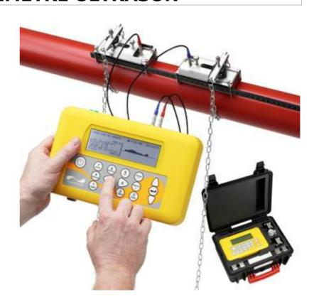
Valise: Le PF330 est livré dans une valise de IP67. **Sondes 'A':** conduites de 13 mm ID à 115 mm. Sondes 'B':- conduites de 50 mm ID à 2000 mm. **Sondes en option:** 'D' pour conduites de > 1500mm de mesure. Jusqu'à 20 blocs enregistreurs à 5000mm.
