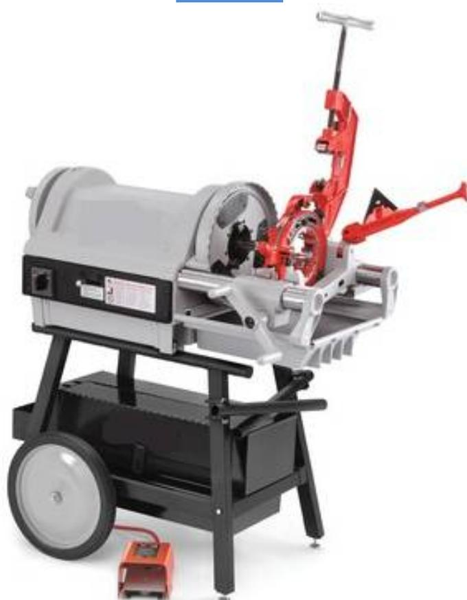
Tête universelle de 1/4" à 2" ; tête à repoussement automatique de 2" 1/2 à 4" permettant de réaliser des filetages taraudés ou droits NPT/NPSM ou BSPT/BSPP. Lubrification + coupe tube et alésoir.
