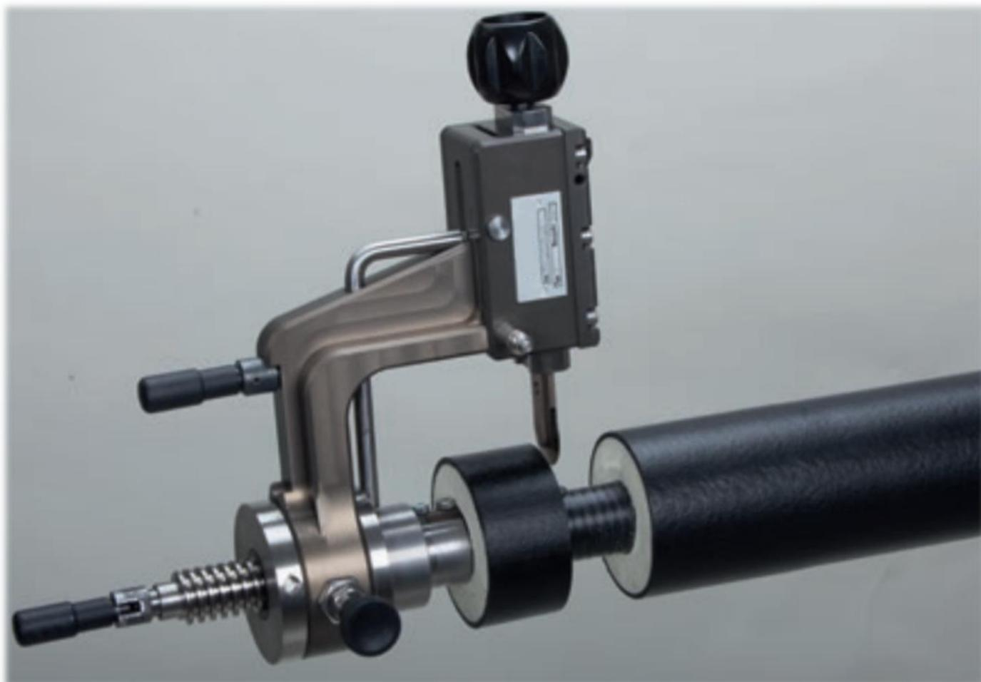
Les tubes COOL-FIT 2.0 sont livrés avec les extrémités dénudées, prêts au montage et au soudage avec les raccords.
