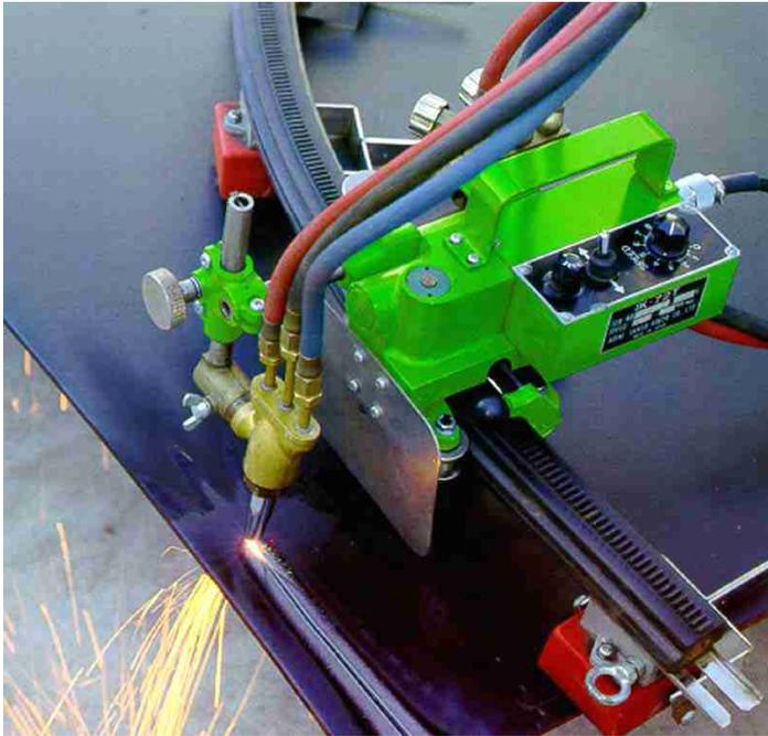
Des surfaces plates aux surfaces à plans multiples, la IK-72T peut découper des formes variées dans l'acier, telles que plaques en U, plaques courbes, avec des angles, etc.
