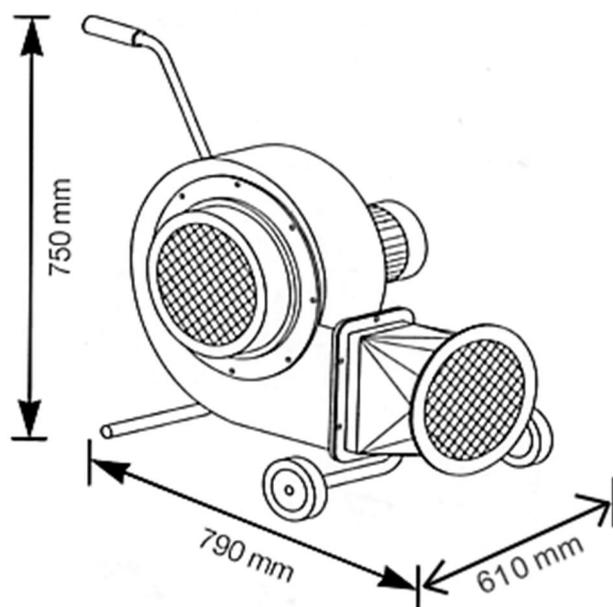
*Ventilateur aspirant, mobile, pour le raccordement d'un flexible Ø 250 mm, disjoncteur et câble d'alimentation.*
