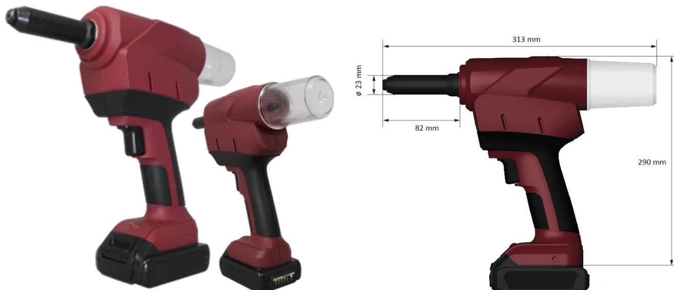
La riveteuse sur batterie performante pour des rivets aveugles jusqu'à 6,4 mm de diamètre en tous matériaux - également pour les rivets haute résistance! Avec une force de pose de 20 000 N et une très grande course de 30 mm, il est possible de poser, en plus des rivets aveugles standards et des rivets haute résistance, également des rivets aveugles étoilés ou des goujons à bague de serrage de manière rapide et fiable sans reprise.
