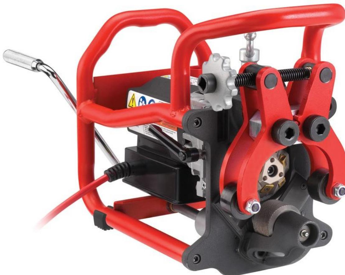
Préparez et chanfreinez les tuyaux acier de 12" de diamètre en moins de 2 minutes à l'aide de la nouvelle machine à chanfreiner les tuyaux transportables.
